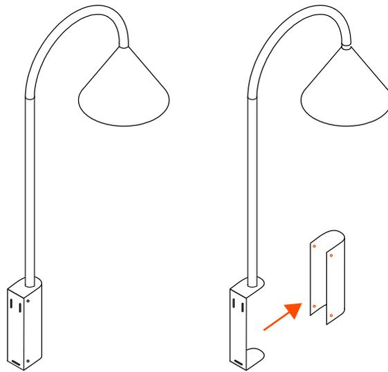
Per procedere al fissaggio della lampada al muro svita le 4 viti presenti sul profilo del basamento, quindi rimuovi la placca.
